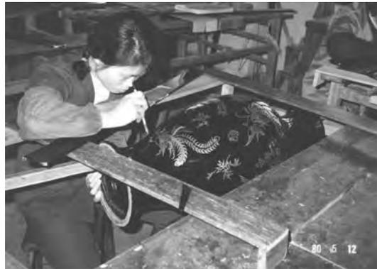
写真5 仕上げ塗りを行う。漆だけの重量なので、製品は極めて軽く耐久性に優れる。
