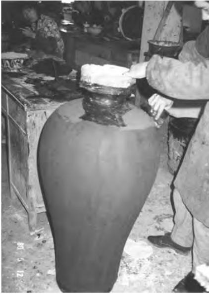
写真3 脱胎漆塗り工程。木・石膏等の「胎」に絹布などを張り、その上に漆を塗り重ねる。
