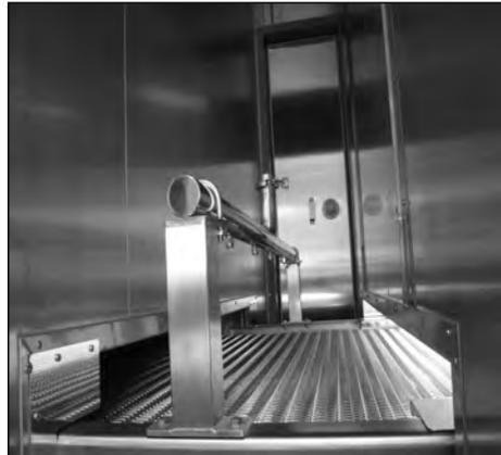
写真④ 全室ベルト洗浄装置付き
