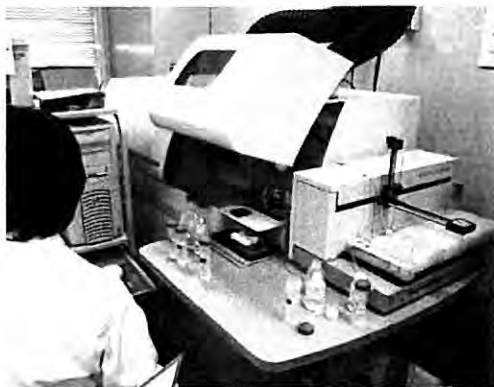
(図6) ICP-AES（発光分析装置）試料をプラズマ（約7000℃の電離気体）中に導入することで元素をイオン化し、イオンが発する光の強さから元素量を求めます。多くの元素を簡便に同時測定することができます。
